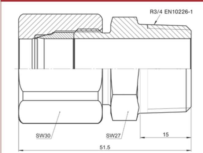
In Verbindung mit Einschiebesensoren bis zu 25 bar/363 psi abs. einsetzbar.
